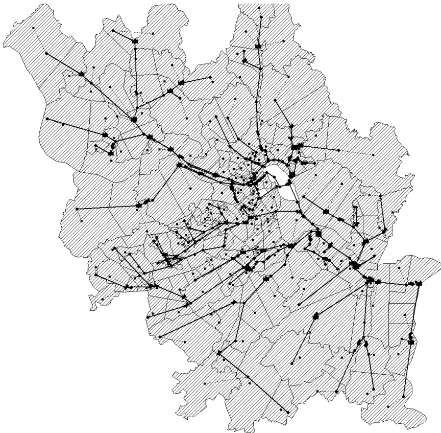
Abbildung 2: Übersicht über das SWMM5 Kanalnetzmodell des Einzugsgebiets Linz (Gamerith et al., accepted-a)
